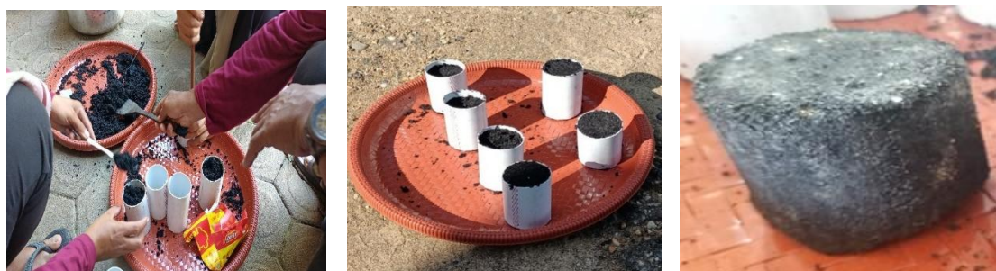
Gambar 6. Pencetakan dan penjemuran briket
