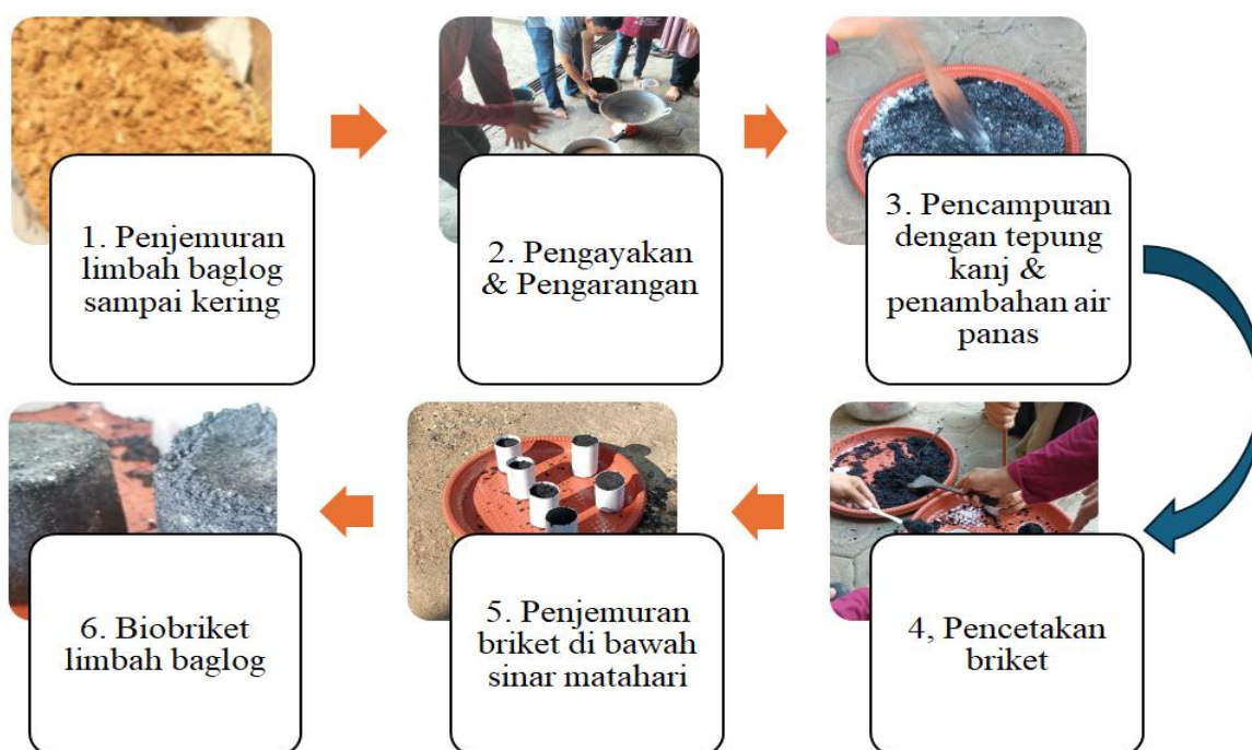
Gambar 4. Proses pembuatan briket dari limbah baglog
